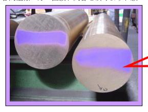
端面に紫着色をして一般材と区別しています。 高性能・高品質はカドミノン CN シリーズも同様!
