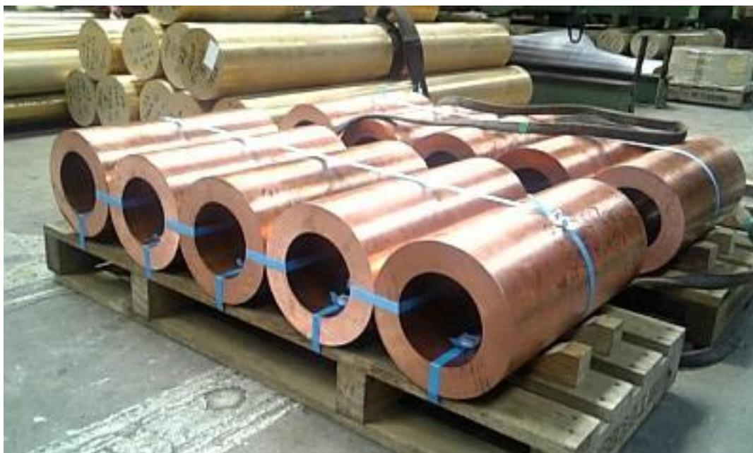
下の写真は、C3771 材の中空鍛造後、機械加工した製品です。
