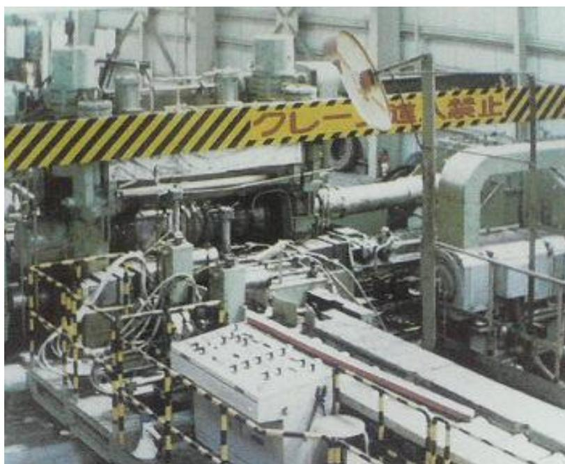
当社が圧延機を使用して製造している銅棒、黄銅棒の最大製品径は 110φ、銅ブスバーの最大製品断面は 20X200 です。
