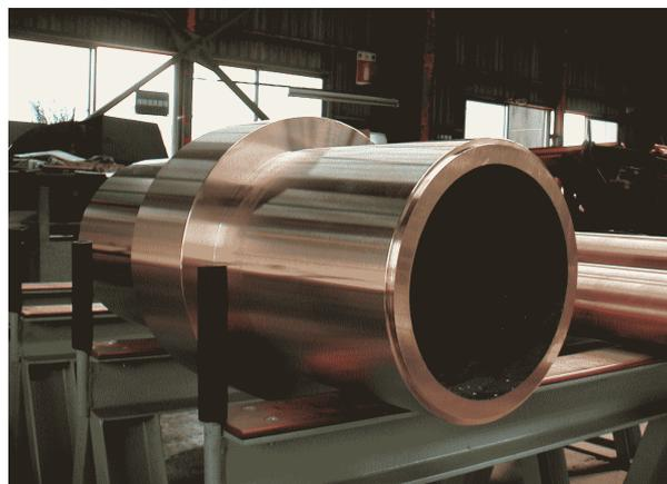
旋盤による機械加工実施外径 460 φ
