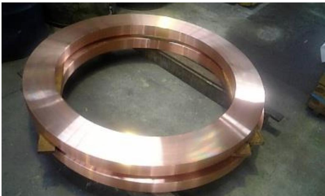
中空鍛造で製造したパイプ形状の材料を汎用旋盤で加工すると公差は、 $\pm 1\text{ mm}$ 程度です。内径に特に厳しい公差を要求されるお客様には、ホーニング加工(内径を再加工)する事で $\pm 0.02\text{ mm}$ の公差で対応する事ができます。
