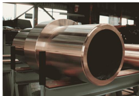
NC 旋盤による機械加工実施
