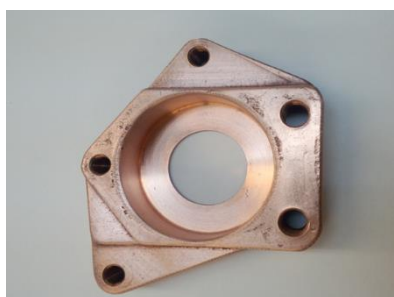
(素材:タピッチ 加工:型打鍛造 重量:674g)
