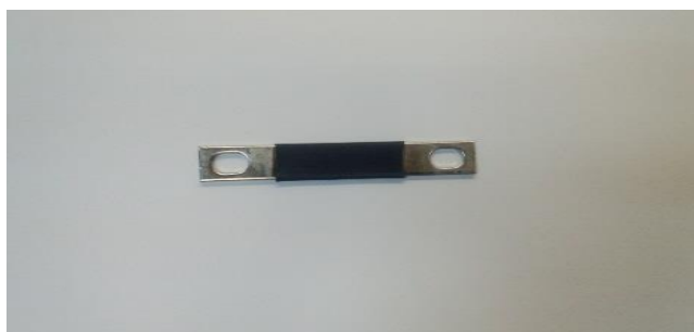
(素材:無酸素銅条 加工:プレス/メッキ/チューブ 重量:40g)
