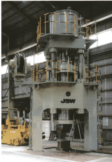
1,000トンプレス 1,000-ton forging press
