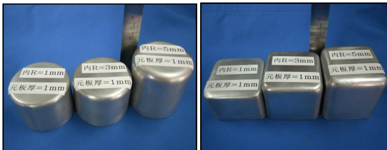
▲円筒形 (厚さ 1.0 mmの圧延研磨板を使用) 角形▲ 左から パンチ R 1 mm・3 mm・5 mm
