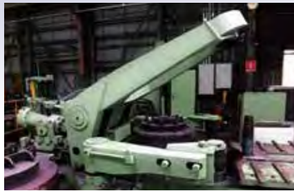
銅・黄銅丸棒に穴を空け、それを広げてつなぎ目のないリングを作り出す「リングローリングミル」
