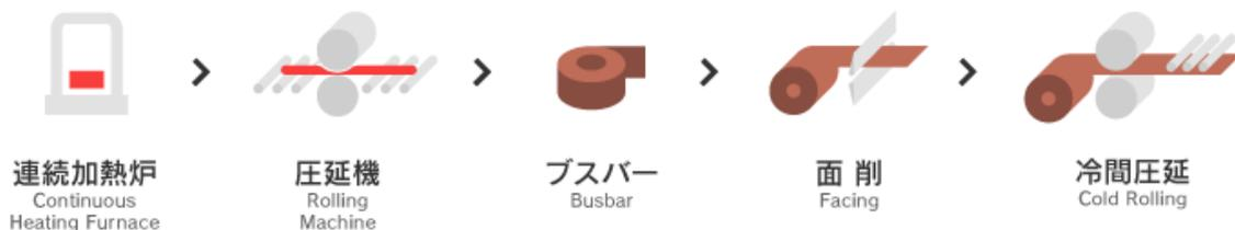
最終サイズを確定する冷間ロールは、幅寄せロールにより側面形状を決めるようになっております。その為、ユーザー様ご希望のサイズがインチサイズ(例・・8×56・10×126 など)でも、ユーザー様のコスト負担無しにご希望の厚さ、幅の銅ブスバーが製造できます。
