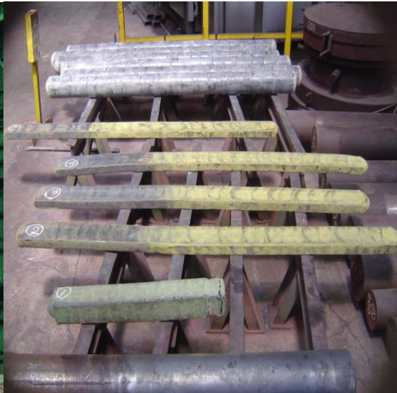
熱間鍛造後のニッケル材料 (奥から丸棒形状、平角形状、四角棒形状)
