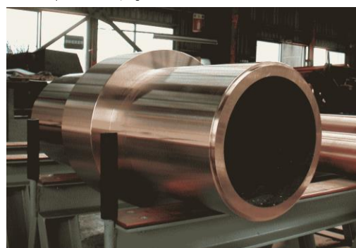
NC 旋盤による機械加工実施
