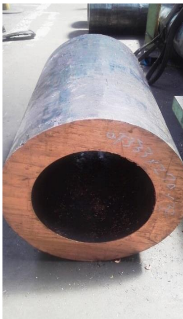
中空鍛造品(内外径未加工状態)
