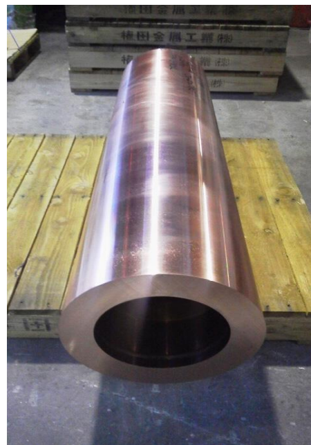
完成品(内径BTA加工後→当社で外径旋盤)
