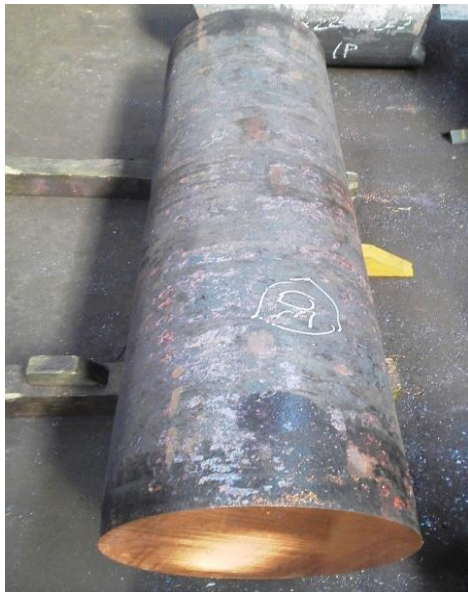
無垢の丸棒(外径鍛造・表面黒皮状態)
